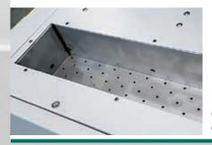
Inoltre, **per minimizzare la manutezione**, le parti in contatto con l'acqua sono incorrodibili: inox **AISI 304** oppure **PVC**.
